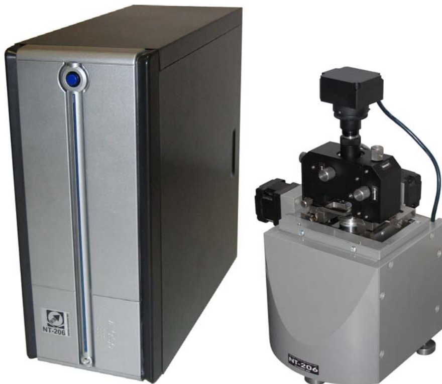
Рис. 1.1. Общий вид атомно-силового микроскопа NT-206 в базовой конфигурации: блок сканирования (справа) с блоком электроники управления (слева).
