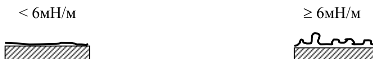
Рис. 2. Схематическое представление пленки ПВП на твердой поверхности в зависимости от значения поверхностного давления на монослой
